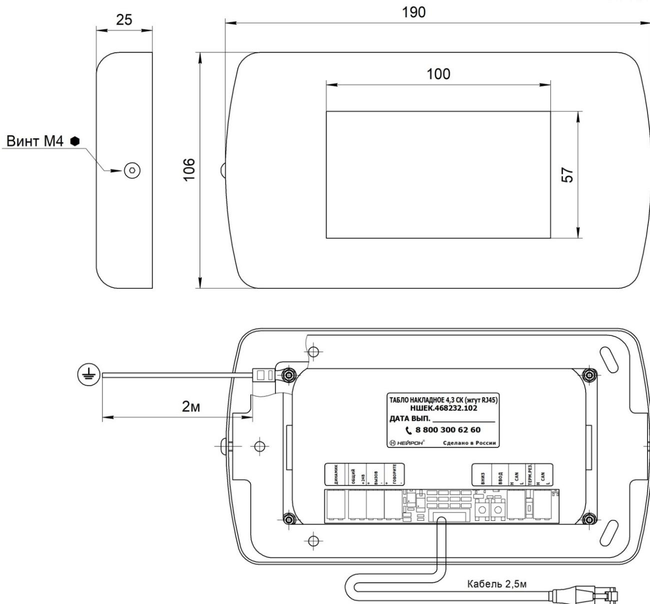
Рис.1 Внешний вид Табло накладное 4,3 СК (жгут RJ45) НШЕК.468232.102
